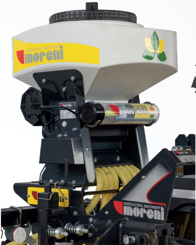
**PRESSURIZED SEED HOPPER: SEEDS MIX INSIDE THE HOPPER IS "SUSPENDED" AND THE INCIDENCE OF DIFFERENT SPECIFIC WEIGHTS IS MINIMIZED. HOMOGENEOUS MIX IS GUARANTEED.**
